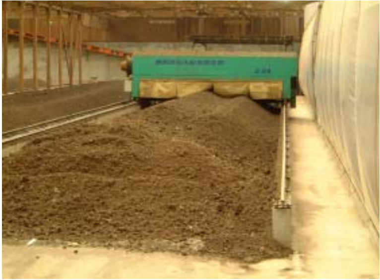
丘状形成の攪拌爪を使用しているため擁壁の高さを少なめにしても、堆積容量を確保でき、かつ通気性よいため良好な発酵を得られる。
