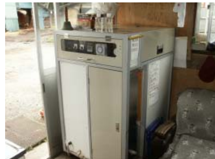
EM原菌(原液)を100倍に培養する培養機。これで、作った100倍液をさらに温室で10倍にした1,000倍液を様々な方法で使用する。
